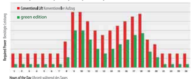
Sample diagram: Power required from an office building lift Indikatives Diagramm der benötigten Aufzugs-Leistung in einem Bürogebäude
